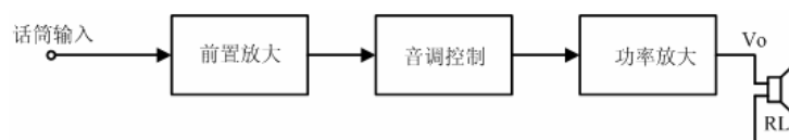
图 6.1.1 声音信号放大流程
