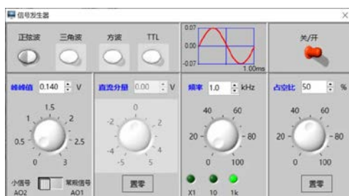
图 1.4.4 信号源幅值 U_s = 140\text{mV} (峰-峰值)
