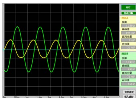
图 1.5.4 R_e=200\Omega 时最大不失真输出 U_{opp}=10V (空载)
