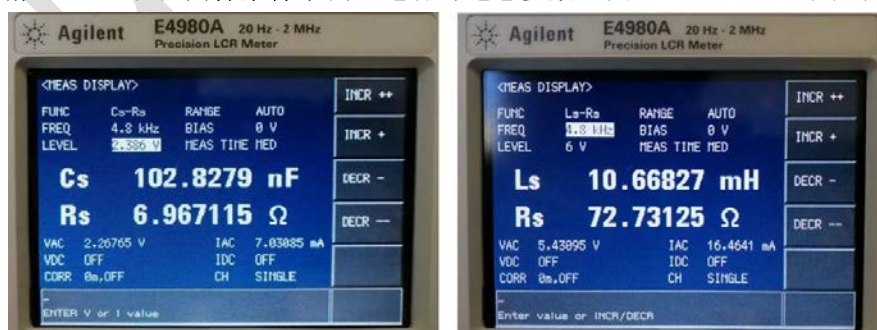
图 2.4.8 精密 LCR 表测量得到的电容参数（左）电感参数（右）
